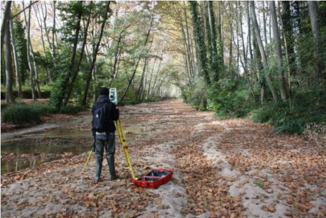
Figura A4. Estació Total Leica TPS1200® utilitzada per obtenir topogràfica just aigües amunt de la segona resclosa del parc de Sant Salvador. Autor: Jordi Tuset
