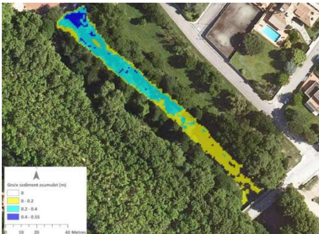
Figura A9. Distribució del gruix de sediment acumulat a la llera en el subtram 1 des del 2016. El gruix del sediment presenta una tendència a la baixa a mesura que s'allunya de la resclosa. El gruix màxim de sediment acumulat és d'aproximadament 50 cm, un valor semblant a l'estimat a partir de dues fotografies de la resclosa corresponents als anys 2017 i 2021.
